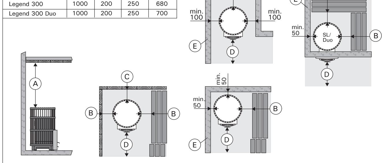
Kuva 9. Suojaetäisyydet (mitat millimetreinä)
