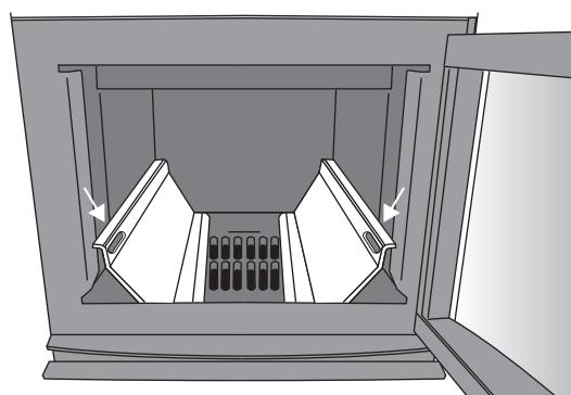
**Рисунок 2. Каналы для подачи воздуха для горения**
