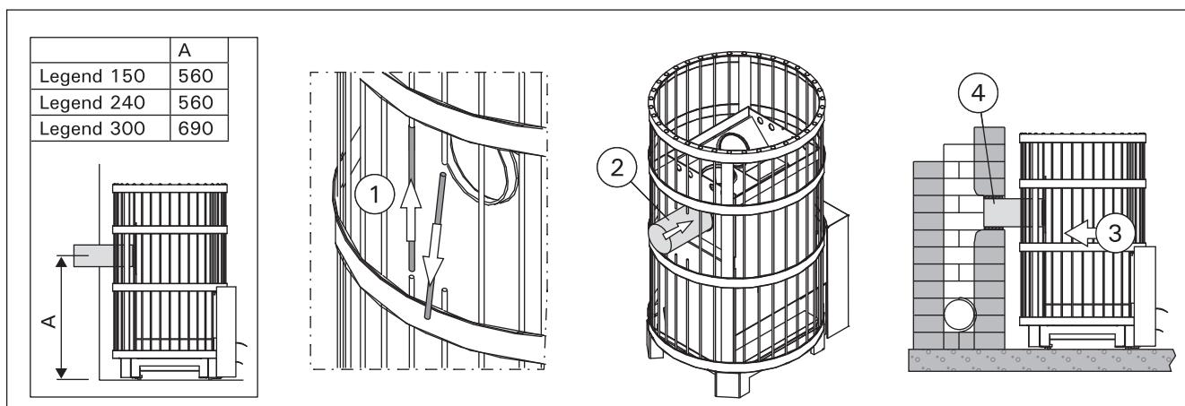
Kuva 11. Kiukaan liittäminen muurattuun savuhormiin takaliitäntääukon kautta (mitat millimetreinä)
